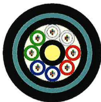
- Figura : cable de 64 fibras ópticas -
